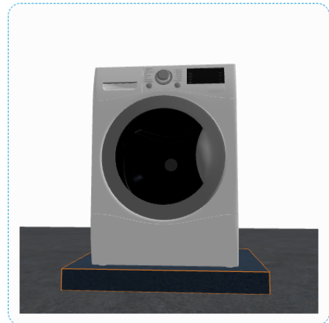
(b) Mit Maschinenfundament
